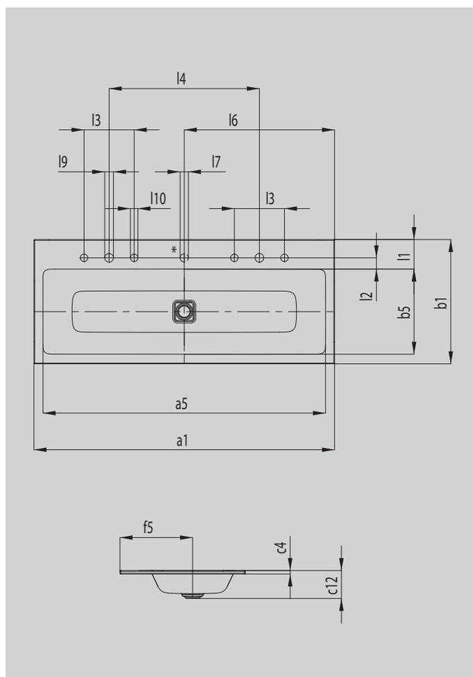
\*Perforaciones de botón giratorio para válvula de desagüe y de rebose CLOU con cable y botón giratorio
