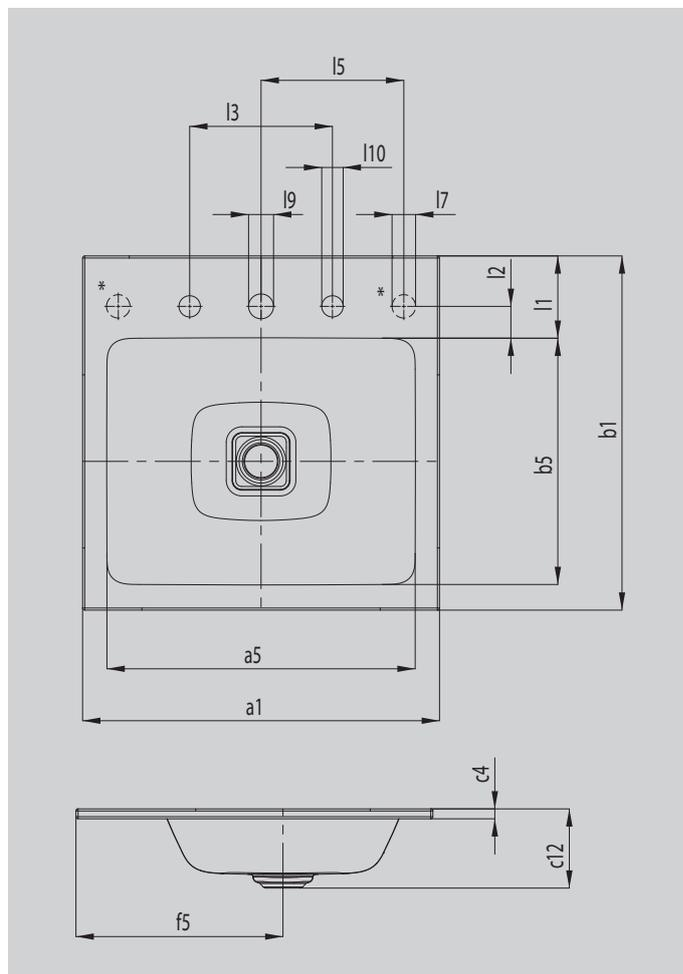
\*Perforaciones de botón giratorio para válvula de desagüe y de rebosé CLOU con cable y botón giratorio a izquierda o derecha según se desee
