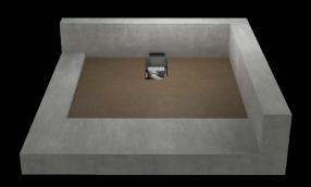
Quindi si ha la compensazione delle altezze con la realizzazione di un massetto o – senza tempi di asciugatura – con degli elementi di supporto in materiale espanso rigido. Per determinare l'altezza giusta vedere le istruzioni per il montaggio o utilizzare gli strumenti interattivi di progettazione on-line.
